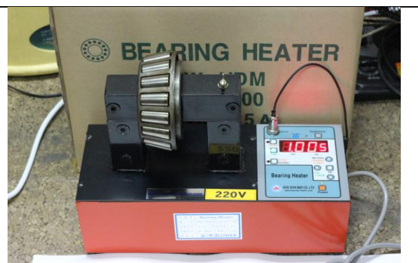
타이머모드 베어링 곁어서 장착 (온도센서 베어링에 부착 안함)
