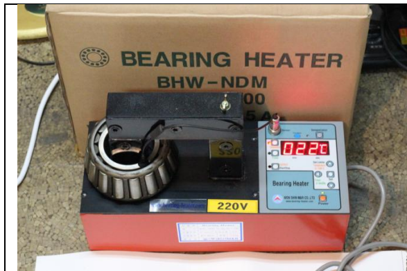
온도모드 베어링 수평 장착 (온도센서 베어링내륜 부착)
