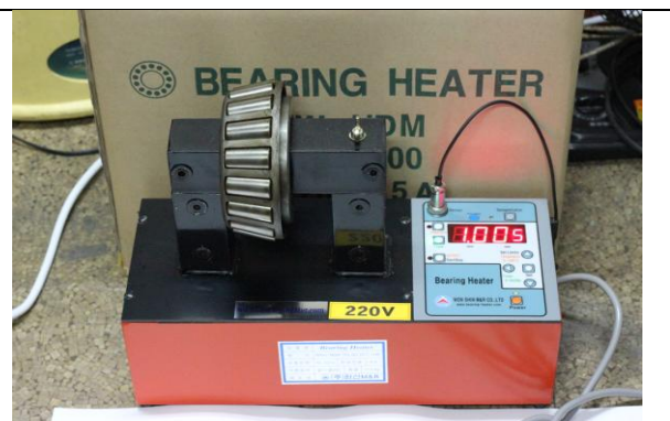
타이머모드 베어링 걸어서 장착 (온도센서 베어링에 부착 안함)
