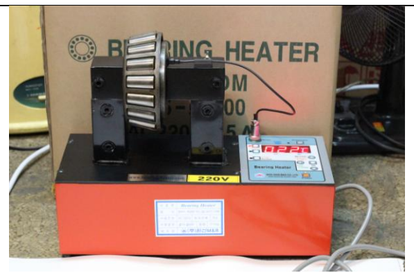
온도모드 베어링 걸어서 장착 (온도센서 베어링내륜 부착)
