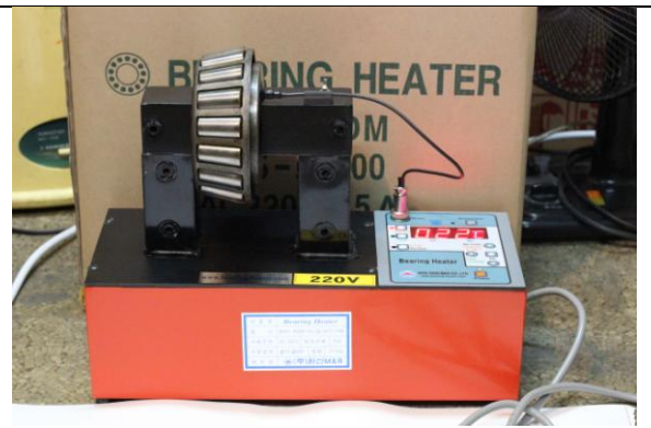
온도모드 베어링 곁어서 장착 (온도센서 베어링내륜 부착)
