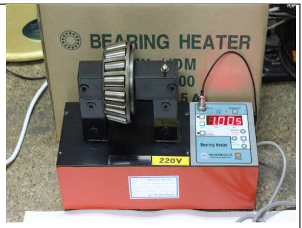
타이머모드 베어링 걸어서 장착 (온도센서 베어링에 부착 안함)
