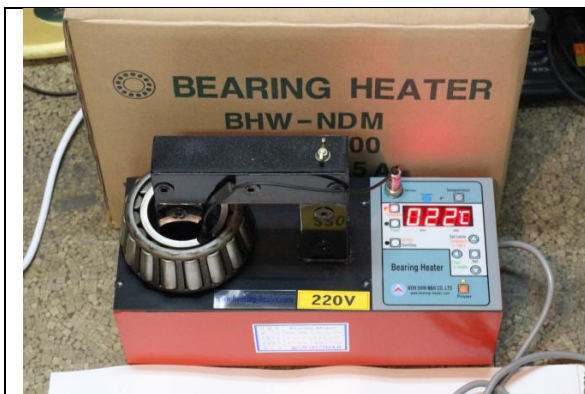
온도모드 베어링 수평 장착 (온도센서 베어링내륜 부착)
