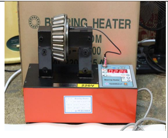
온도모드 베어링 걸어서 장착 (온도센서 베어링내륜 부착)
