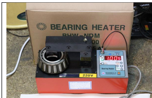
타이머모드 베어링 수평 장착 (온도센서 베어링에 부착 안함)
