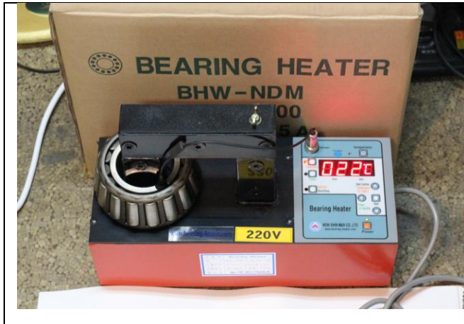
온도모드 베어링 수평 장착 (온도센서 베어링내륜 부착)
