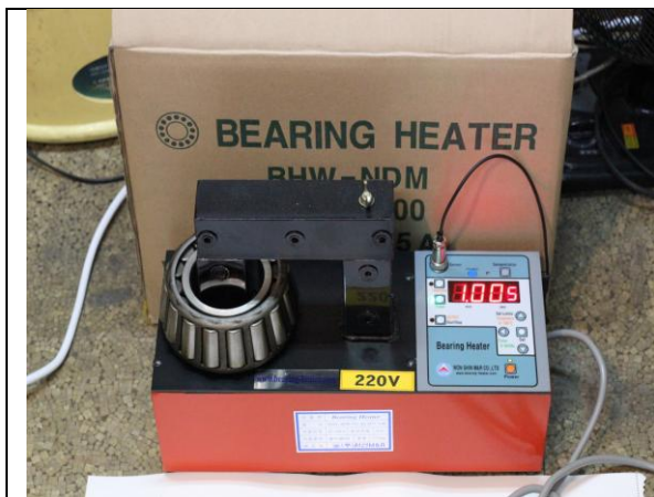
타이머모드 베어링 수평 장착 (온도센서 베어링에 부착 안함)
